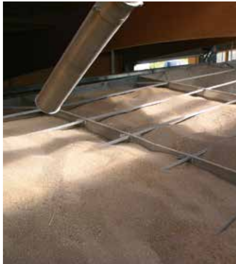
Rechteck-Lagersilo Silozellen befüllt
