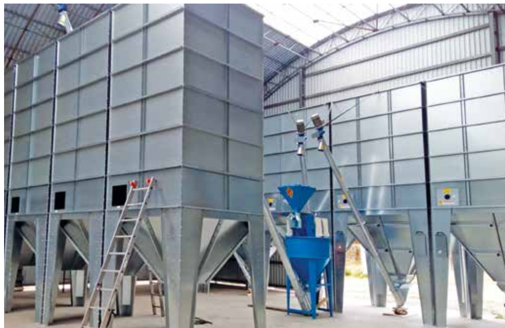
HIMEL Modulsilos mit Hochleistungsmühle
