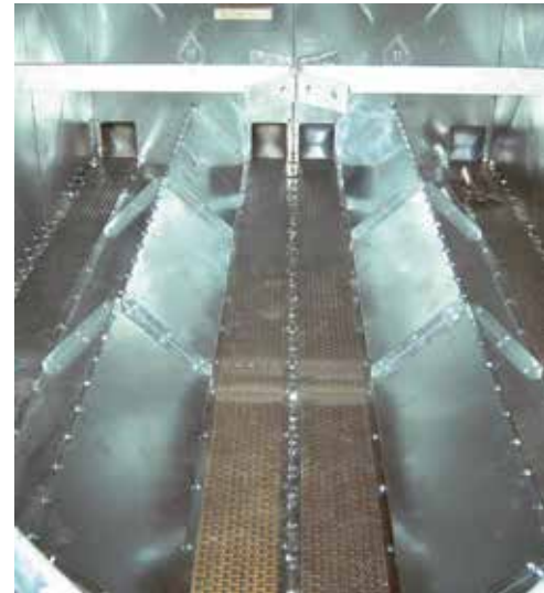
Rechtecklagersilo mit Belüftungsboden
