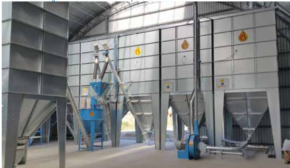
Mahl- Mischanlage mit Modusilo 60° als Komponentensilos
