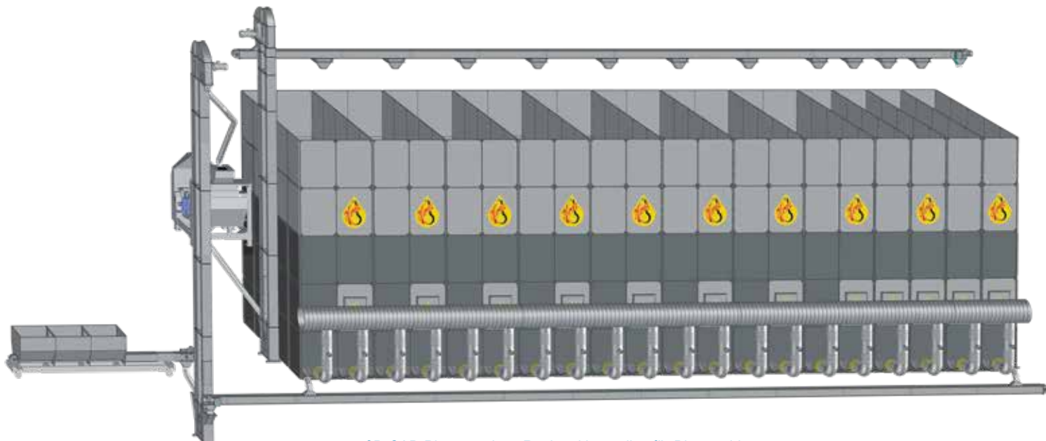
3D CAD Planung eines Rechtecklagersilos für Biogetreide
