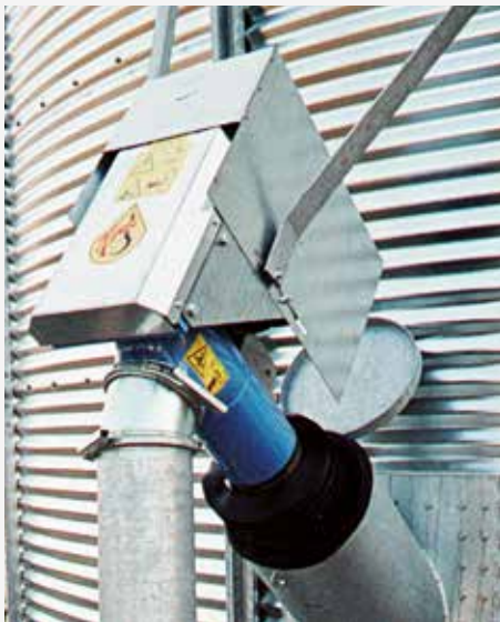
Faltbalg für Abdichtung Entnahmerohr
