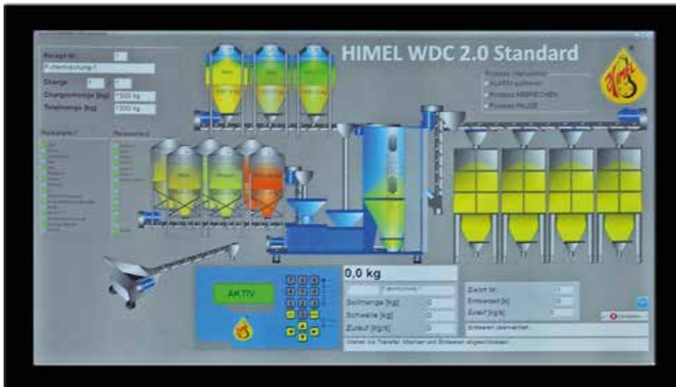
HIMEL Visualisierung einer Mahl- & Mischanlage auf einem Android-Tablet
