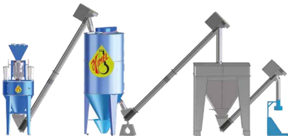
Schema Mahl- & Mischanlage mit Plattformwaage
