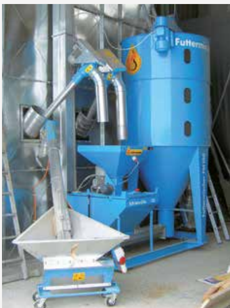
HIMEL Mahl-Mischanlage, Futtermischer FMK 180 mit SC - Mühle
