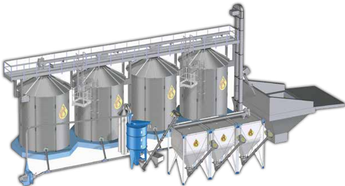
Vollautomatische Mahl- & Mischanlage mit Gebläseabsaugung
