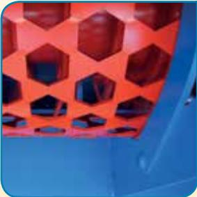
Auf Wunsch lässt sich der Ballenauflöser mit einem Siebkorb zu einer Ballenmühle umrüsten, wodurch das aufgelöste Stroh eine vordefinierte Länge bekommt.
