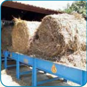
Auf Wunsch kann der stationäre Ballenauflöser um einen motorbetriebenen Vorlegetisch in 2,9m oder 5,8m Länge erweitert werden. Der Vortrieb erfolgt per Knopfdruck oder Fernbedienung.
