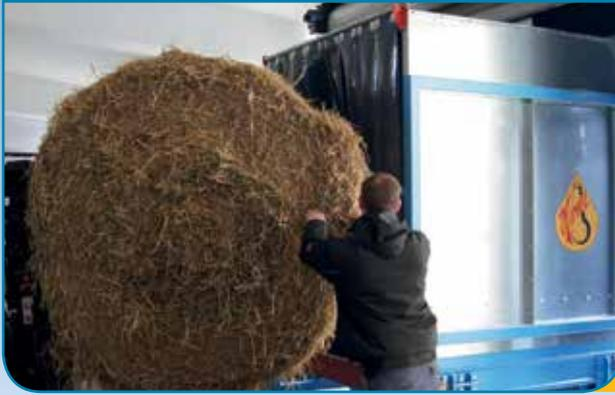
Der stationäre Ballenauflöser löst Rund- oder Quaderballen auf. Das Stroh kann je nach Ausführung einer oder zwei Strohmühlen zugeführt werden. Durch die stationäre Strohmühleneinheit erledigen Sie in einem Arbeitsgang das, was bisher in mehreren Arbeitsschritten in Handarbeit durchgeführt werden musste und das alles kompakt in einer Einheit. Die gute Qualität des Strohs bleibt dabei erhalten.
