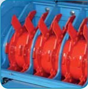
fräst den Ballen durch einen Schneidrotor ab. Zwei separat angetriebene Kettenkratzböden bringen den Ballen in Rotation und sorgen für eine gleichmäßige Materialentnahme.
