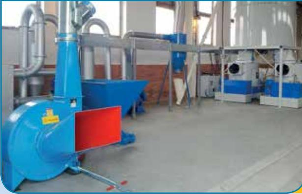
Die leistungsstarke Strohmühle mit Gelenkwellenantrieb oder mit Elektromotor eignet sich besonders gut für den größeren Betrieb. Die Strohmühle saugt das Mahlgut vom Boden ab und verarbeitet es in einem groß dimensionierten Mahlraum zu Kurzstroh. Abhängig von der Antriebsleistung und der Siebgröße, kann eine Durchsatzleistung von bis zu 2.5 to/h erreicht werden. Die qualitativ hochwertigen Messer halten hohe Standzeiten aus und sind bei Bedarf dennoch leicht auswechselbar.
