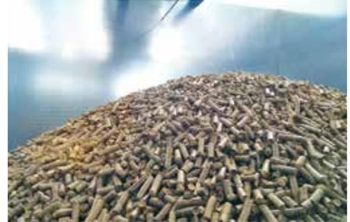
Pelletkühlung im Belüftungssilo
