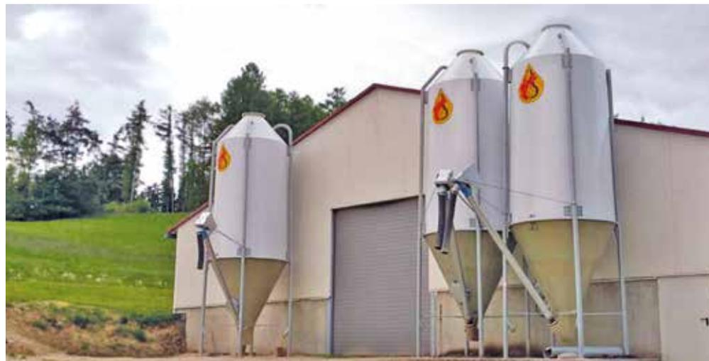
GFK Mischfuttersilo mit Förderschnecken per Funk
