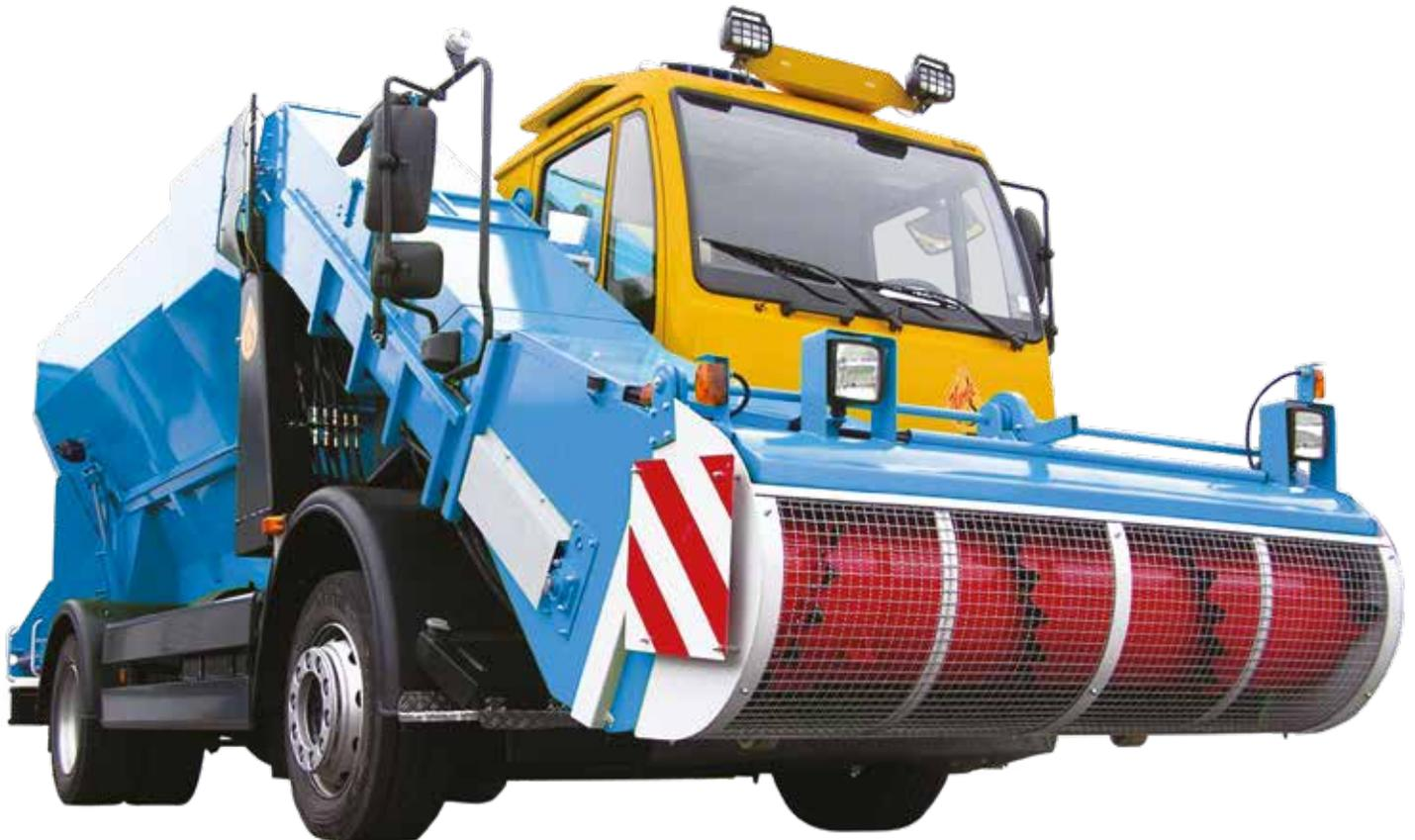
Selbstfahrer SF120 mit Fräse und 3 Schnecken Mischsystem
