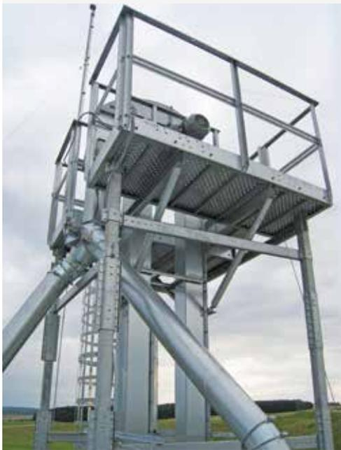
Becherelevator mit Bedienpodest
