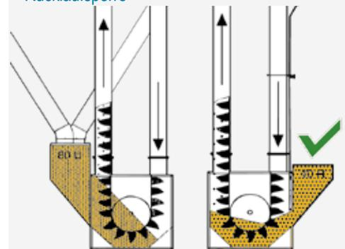
Die Materialzufuhr in die aufsteigenden Becher kann zu ca. 40 % verminderter Leistung führen.
