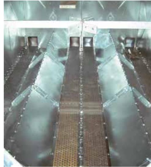
Rechtecklagersilo mit Belüftungsboden
