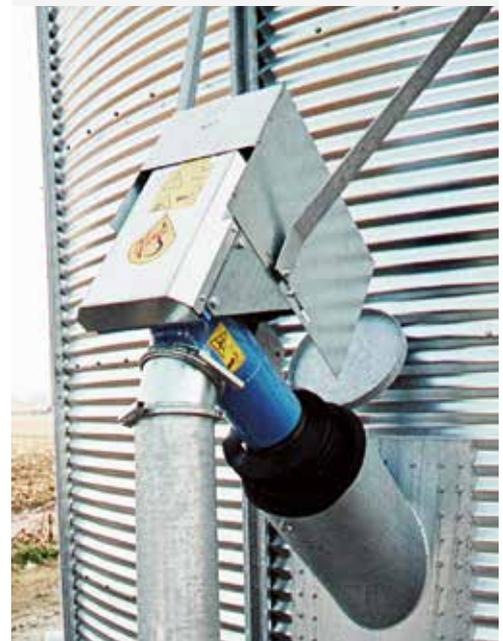
Faltbalg für Abdichtung Entnahmerohr
