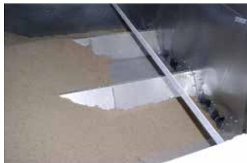
Dachreiter-Belüftungskanäle im eingebauten Zustand
