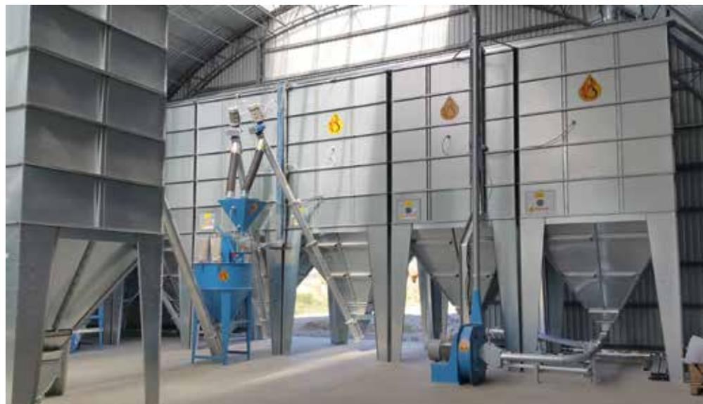
Mahl- Mischanlage mit Modulsilo 60° als Komponentensilos
