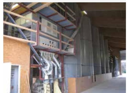
Anlage mit 4000 t Lager und Siebreiniger
