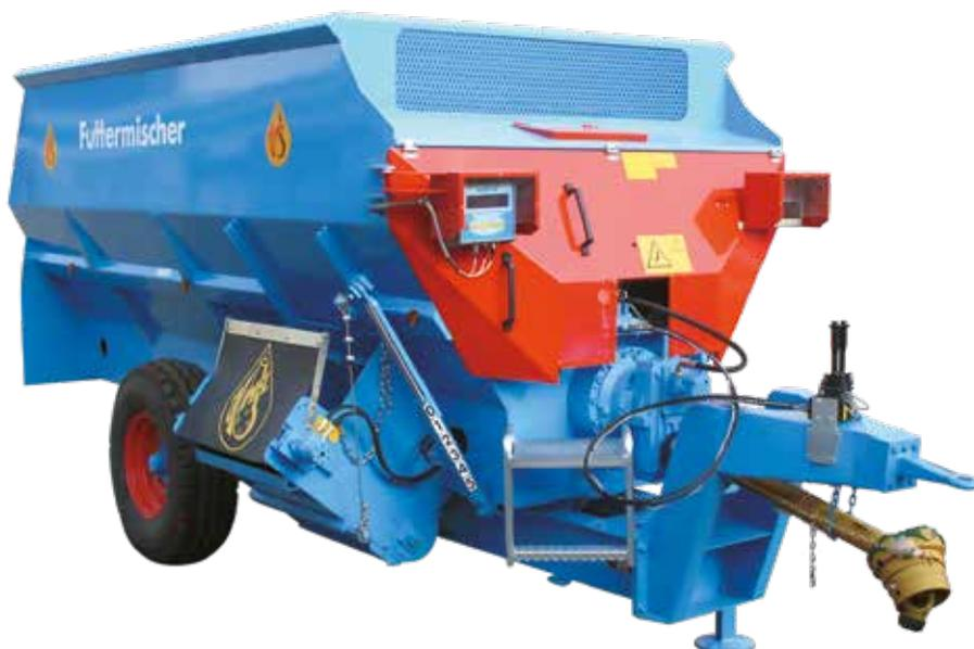
Füttermischwagen H88 mit Auswurf vorne, Wiegecomputer und Flexzugsteuerung
