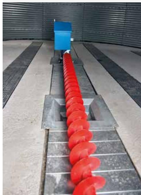
Fegeschnecke im Silo mit Belüftungskanälen
