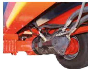
Achsantrieb mit Differentialsperre
