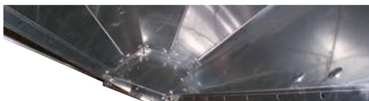
Innenansicht Auslaufrichter mit Schieber
