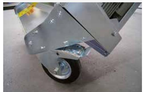
Schwenkbare Räder für Abladestation
