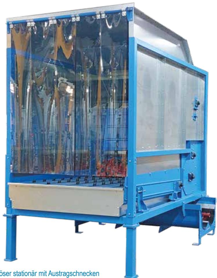
Ballenauflöser stationär mit Austragschnecken
