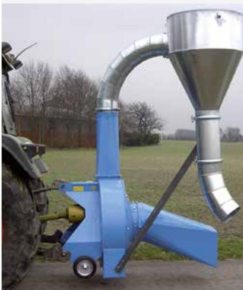
Strohmühle STZ mit Zyklon
