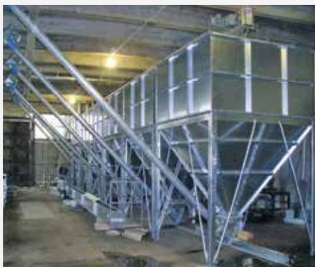
Modulsilos in einer Mahl- & Mischanlage
