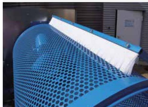
Bürste zur Reinigung der Siebtrommel
