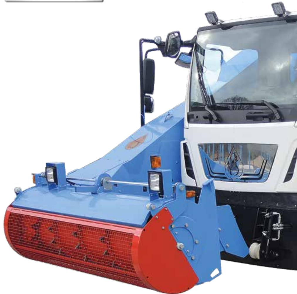
Selbstfahrer SF140S mit Fräse und 3 Schnecken Mischsystem
