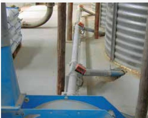
Siloentnahme über Saugventile
