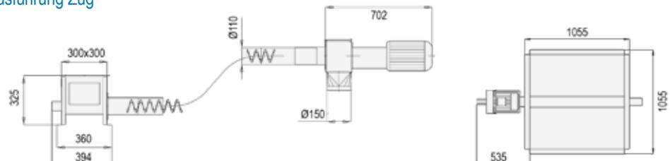
Antriebsstation Ø75 mit Dosierbehälter 1x1 m, Inhalt 0,5 m<sup>3</sup>
