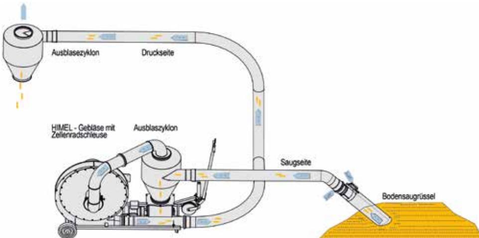
Funktionsweise eines HIMEL Körnergebläses im Saug & Druckbetrieb
