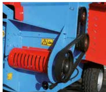
RSM Turbo Keilriemenantrieb
