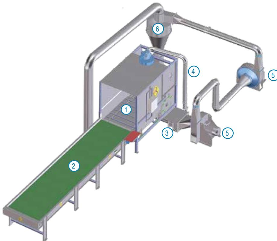
Stationäre Ballenauflöseanlage mit zwei HIMEL Strohmühlen
