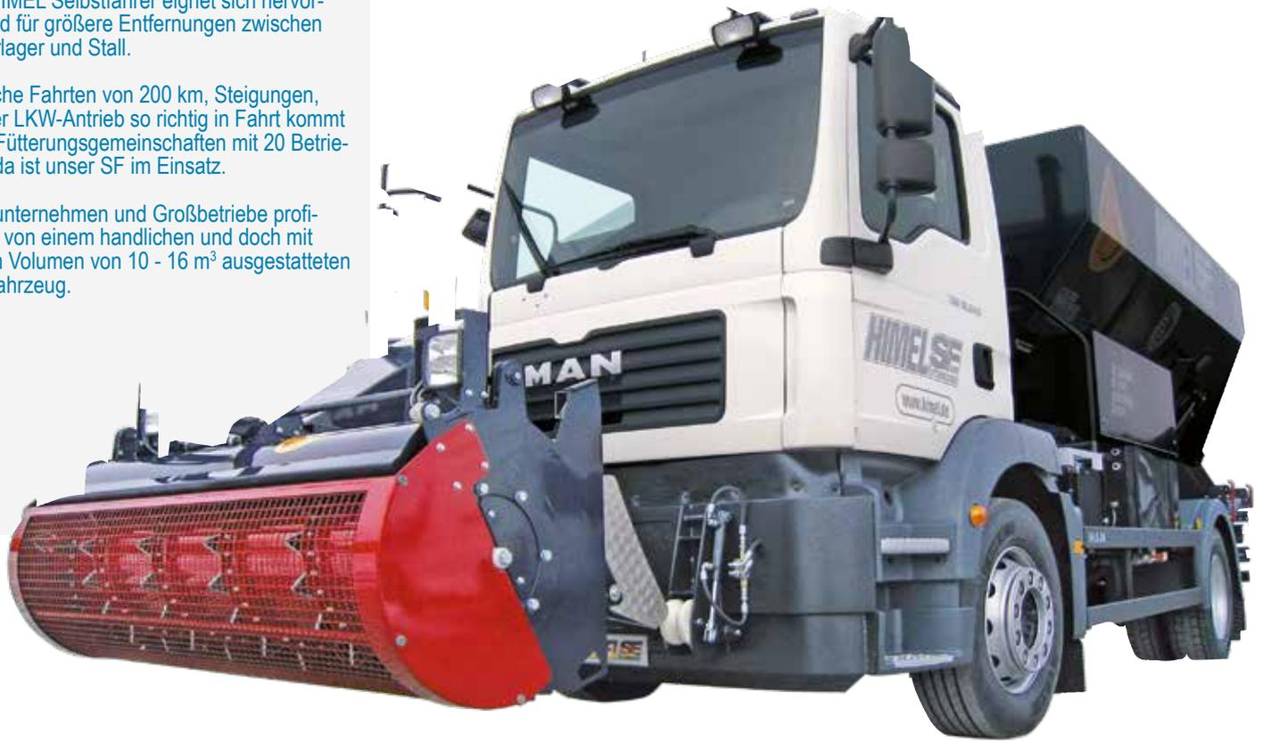
Futtermischwagen SF160 mit Hochleistungsfräse
